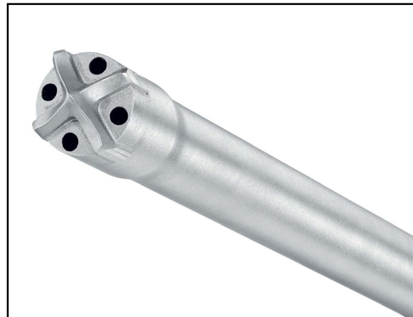
De afzuigopeningen in de kop van de Hilti TE-CD 12/33 holle betonboor
