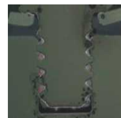
Befestigungsmechanik des S-BT Bolzens in Stahl
