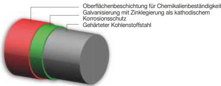
S-BT Kohlenstoffstahlbolzen mit Duplexbeschichtung
