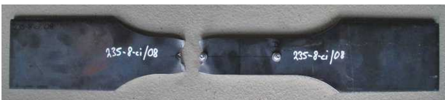
Prüfkörper aus dem Ermüdungsversuch
