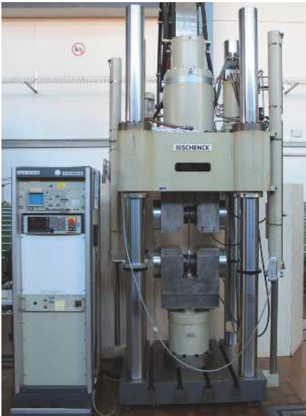
Prüfanordnung für Ermüdungsversuche
