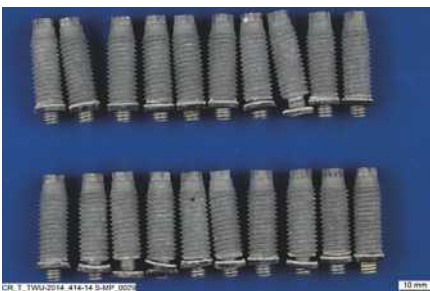
S-BT Gewindeschraubbolzen nach zwölf Wochen zyklischer Korrosionsprüfung gemäß EN ISO 16701. Keine sichtbare Korrosion.
