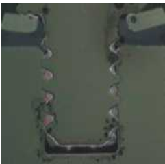
Abbildung eines polierten Schnitts: Aktivierte Mikroverkapselung auf den Schneidgewinde des S-BT Bolzens
