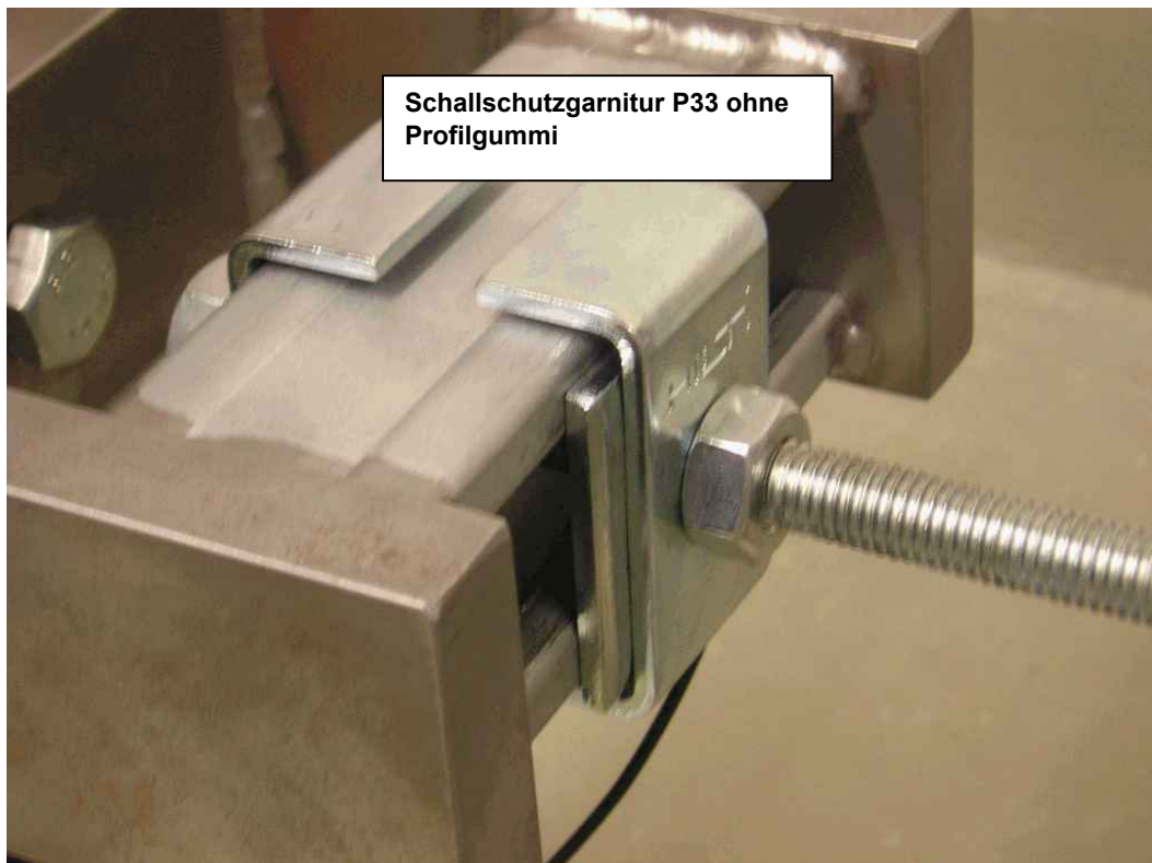
Bild 2. Befestigung der Referenz-Schallschutzgarnitur am Montageschienenadapter MQ 41 mit einer Schienenhöhe von 41 mm
